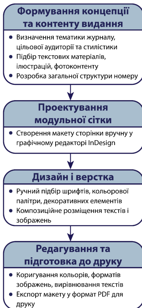
Рисунок 5.1 – Технологічна схема для створення журналу традиційним способом
