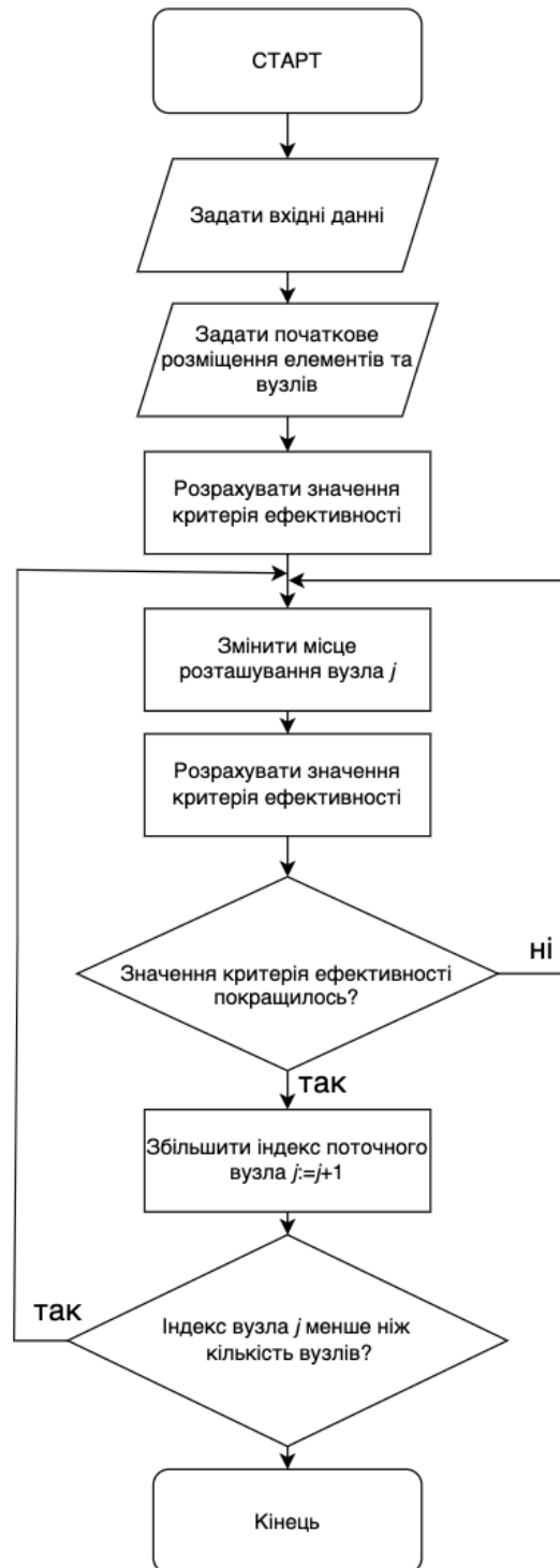
Рисунок 2.4 – Схема алгоритму покоординатної оптимізації топології комп'ютерних мереж CALS-систем
