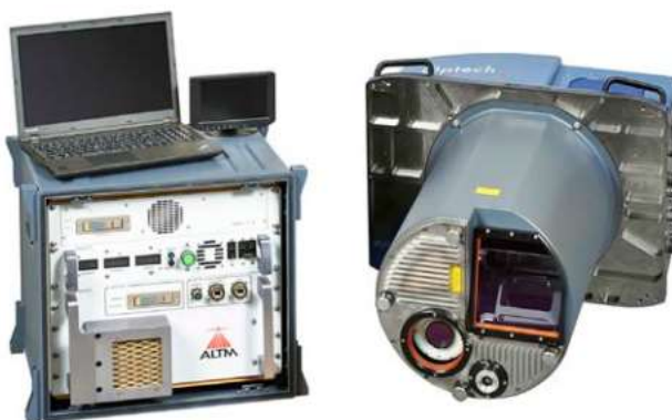
Рисунок 2.1– Titan ALTM - перший комерційний мультиспектральний лідарний датчик с трьома активними каналами довжини хвилі (1550, 1064, і 532 нм)
