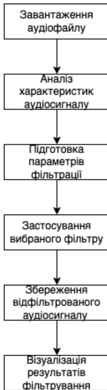
Рисунок 3.2 – Блок-схема потоку даних у додатку
