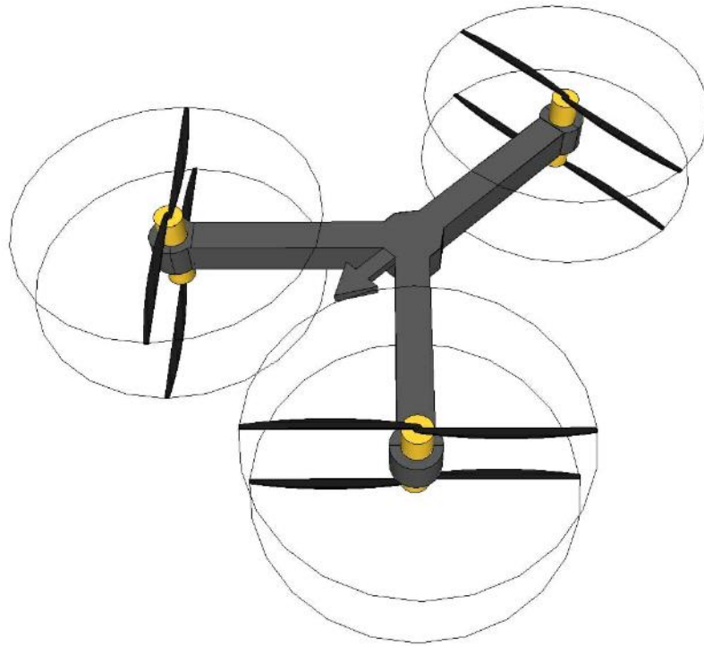
Рисунок 2.4 – Приклад рами БПЛА конструкції Y6 [13]
