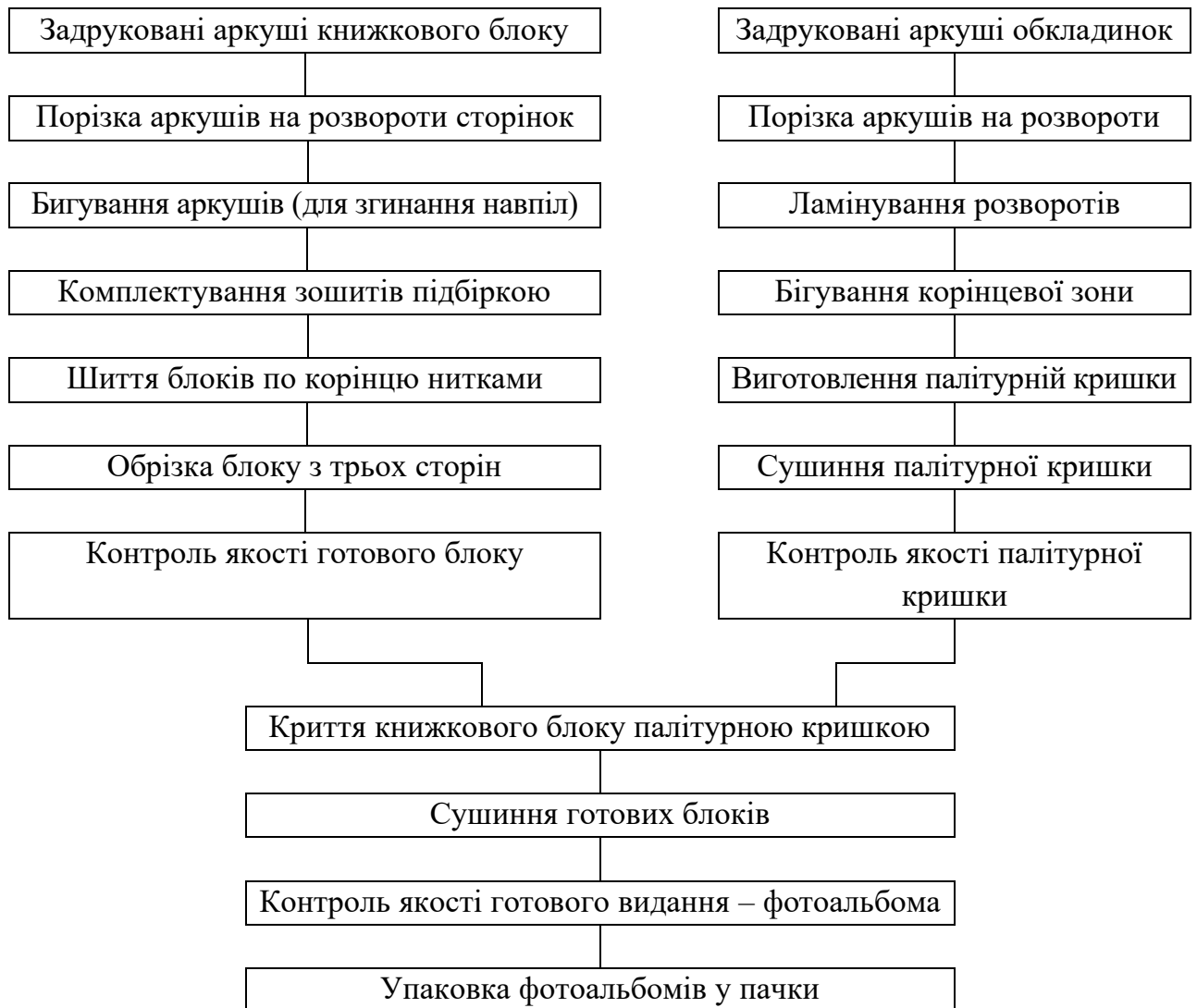
Рисунок 5.1 – Схема післядрукарського етапу виготовлення фотоальбома
