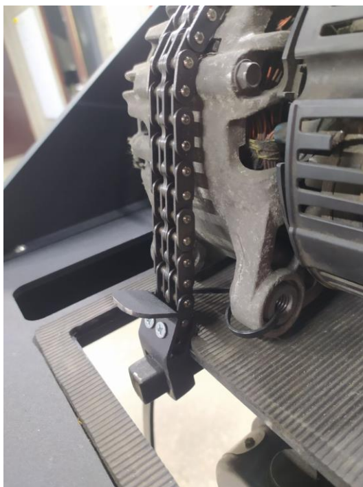
Рисунок 4.4 – Генератор та ланцюг фіксації у закріпленому положенні
