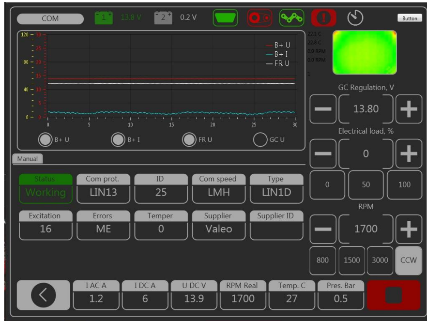
Рисунок 4.19 – Стан генератора після визначення типу протоколу
