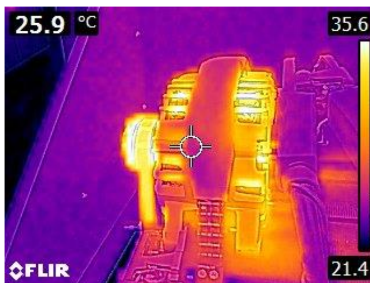
Рисунок 4.21 – Термограма генератора під час роботи
