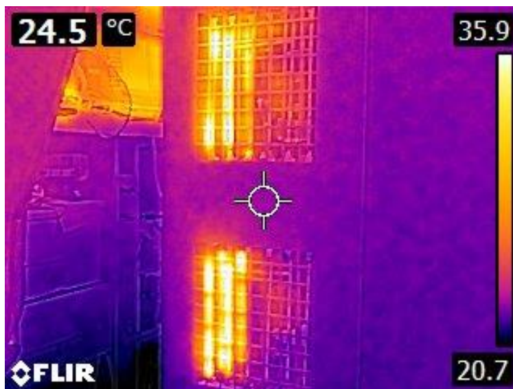
Рисунок 4.20 – Термограма спіралей навантаження під час роботи
