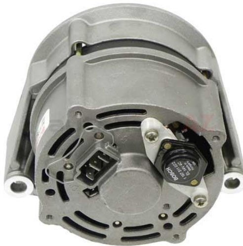
Рисунок 3.1 – Місцезнаходження терміналу обмотки збудження на генераторі [19]
