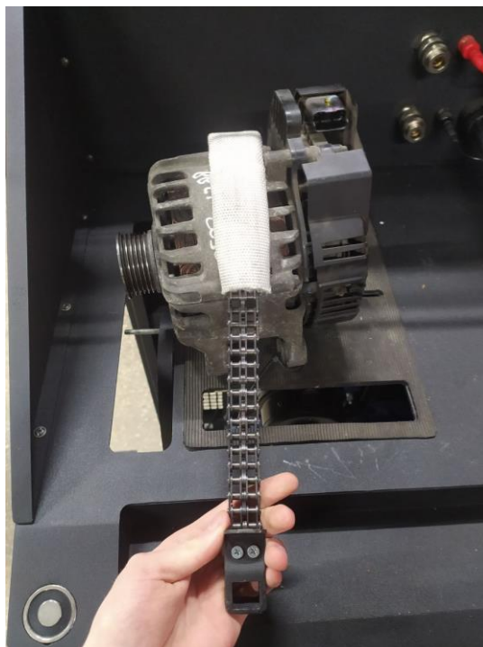
Рисунок 4.3 – Генератор та ланцюг фіксації у незакріпленому положенні
