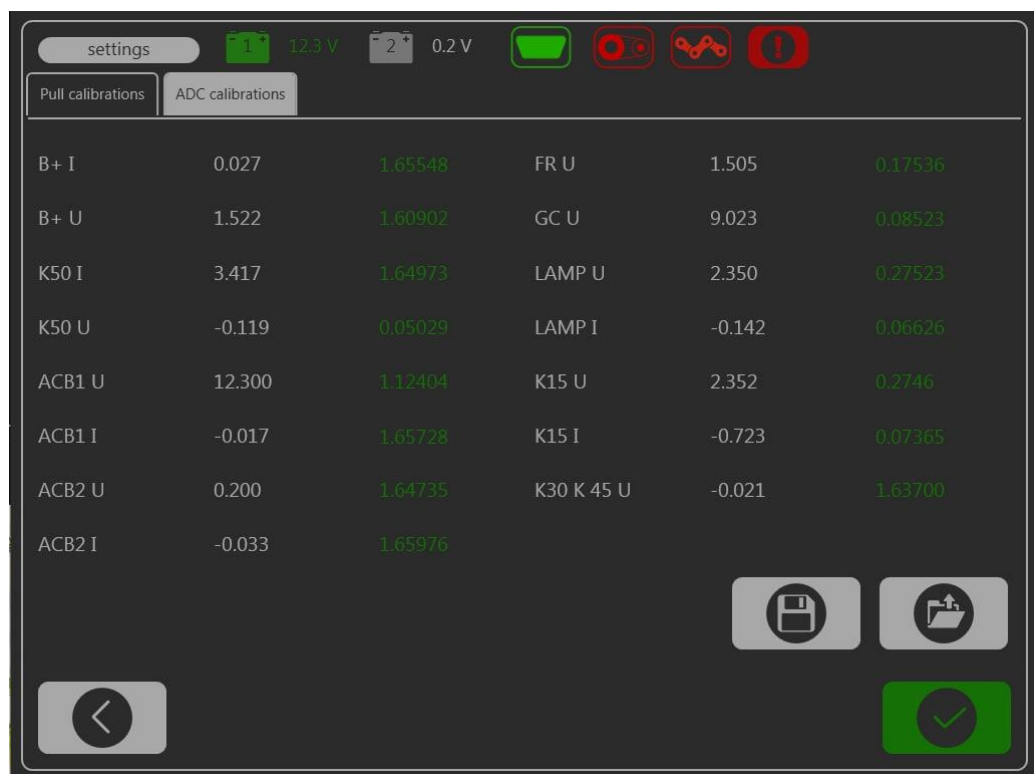
Рисунок 3.26 – Сервісне меню для калібрування вимірюваних параметрів
