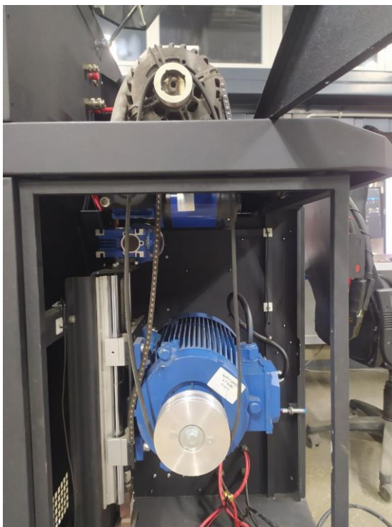
Рисунок 4.6 – Передавальний ремінь у незакріпленому положенні
