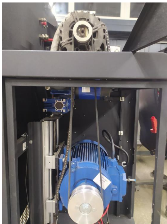
Рисунок 4.7 – Передавальний ремінь у закріпленому положенні
