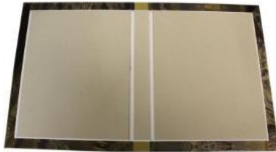
Рисунок 1.1 – Палітурна кришка в зібраному стані
