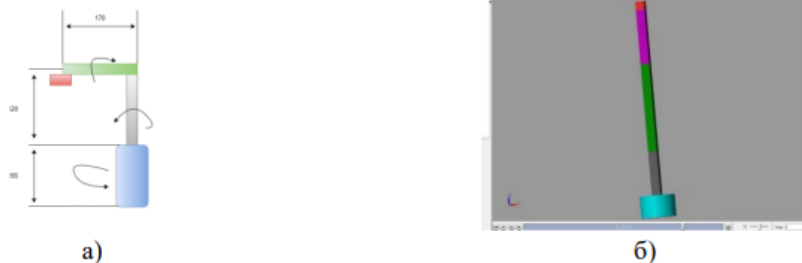
Рисунок 2 – Ескіз маніпулятора робота (а) та його CAD-модель (б)
