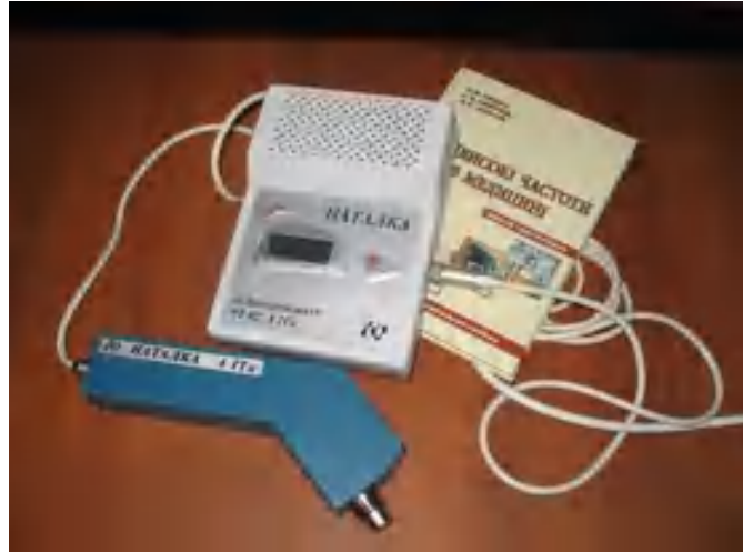
Фото 1 – Зовнішній вигляд радіотермометра «РТ-02-Наталка» на фоні навчального посібника «НВЧ в медицині» [2]
