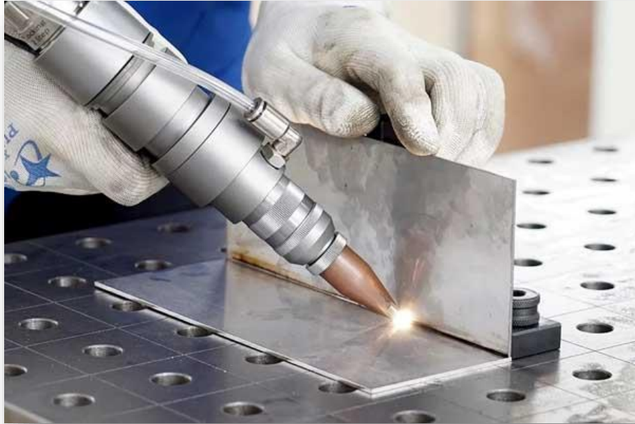
Рисунок 1.1 – Зварювання деталей із близьким приляганням листів із мінімальним відхиленням та локалізованою зоною нагріву
