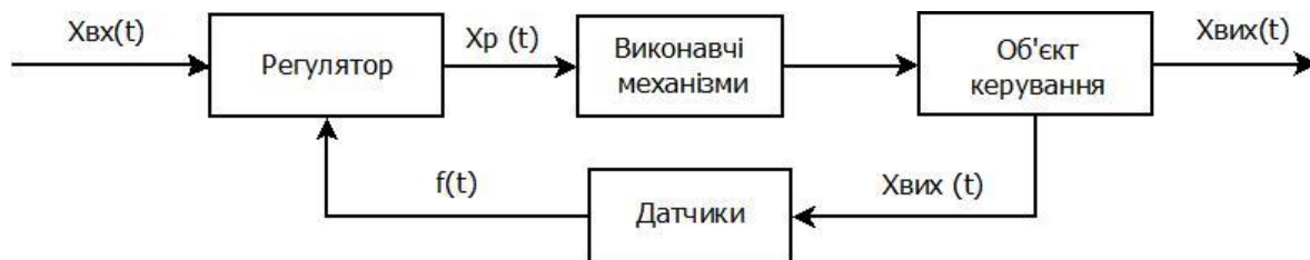
Рисунок 2.3 – Система керування із зворотнім зв'язком.
