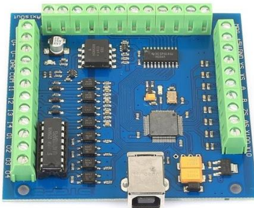
Рисунок 2.7 – Плата керування малогабаритним фрезерним верстатом STB4100
