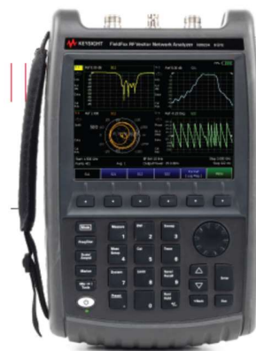
Рисунок 3.3 – Векторний аналізатор кіл Agilent Field Fox N9923A
