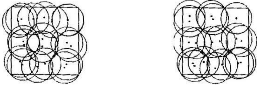
Рисунок 2.13 – 2-кратне оптимальне покриття одиничного квадрата, N = 19 , отримані із застосуванням: зліва - чисельного диференціювання; праворуч - двократної діаграми Вороного
