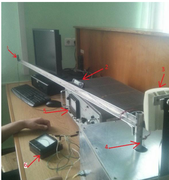
Фото лабораторной установки для экспериментального исследования ИК-датчика движения
