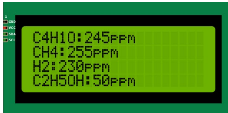
Рис. 3. Вивід даних з датчика MiCS6814: C 4 H 10 , CH 4 , H 2 , C 2 H 5 OH
