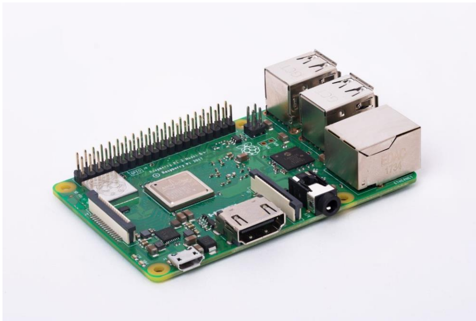
Рисунок 2.2 – Контролер Raspberry Pi 3 Model B+ [26]
