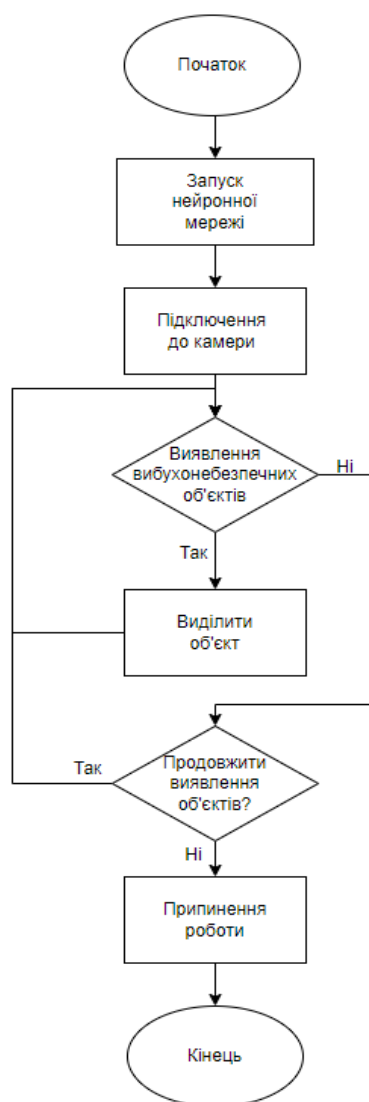
Рисунок 2.4 – Розроблений алгоритм роботи підсистеми виявлення вибухонебезпечних предметів
