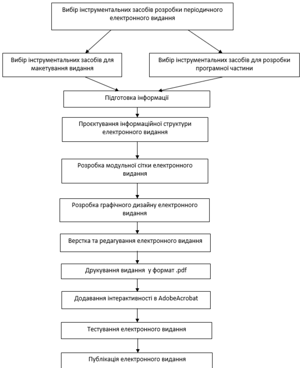
Рисунок 6.1 – Технологічна схема виготовлення інтерактивного журналу
