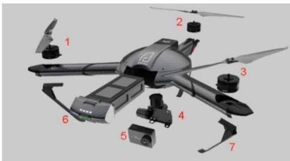
Рисунок 4 – Конструкція БПЛА у залежності від типу має різні елементи 1,2,3 – силові двигуни та гвинти; 4 – карданний підвіс; 5 – активна камера; 6 – відсік з батареєю живлення; 7 – лапа
