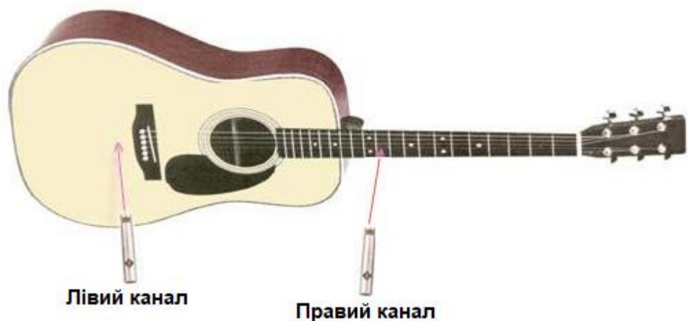
Рисунок 3.2 – Процес запису гітари двома мікрофонами
