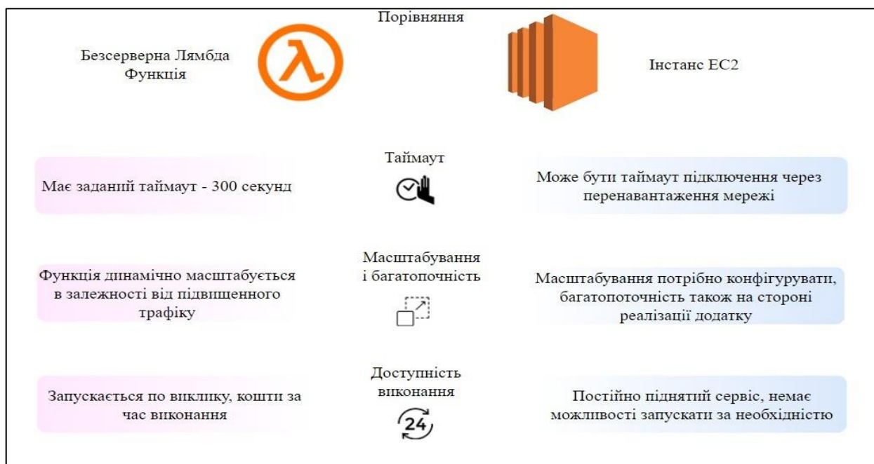
Рисунок 3.6 – Порівняння фізичних екземплярів серверів і безсерверних функцій
