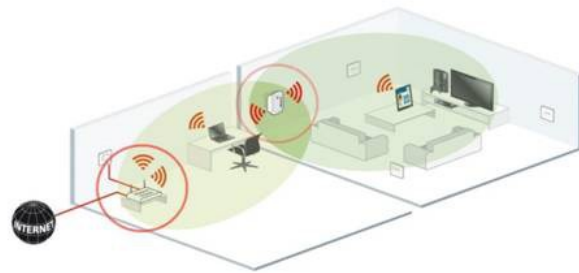
Рис.2 Концепція з використанням пасивного ретранслятора для мережі wi-fi в квартирі
