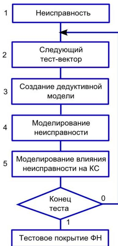
Рис. 4. Модель процесса дедуктивно-параллельного моделирования
