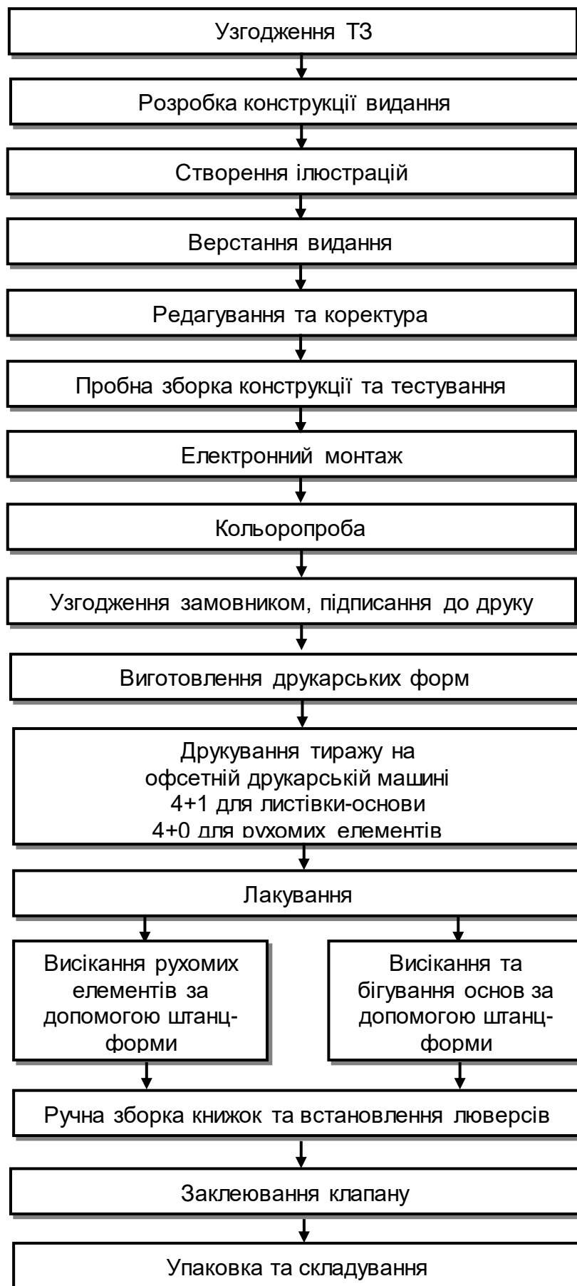
Рисунок 4.2 – Технологія виготовлення книжки-іграшки з рухомими елементами на основі «прихованого» комбінаторного кола
