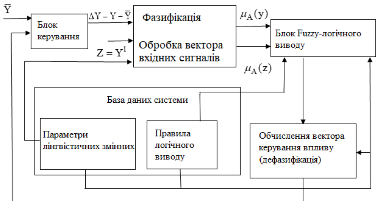
Рисунок 1.3 – Структура основні елементи і змінні Fuzzy-контролера
