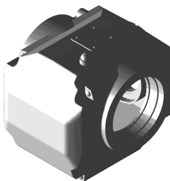
Рисунок 2.7 – Гранний блок обертання маніпулятора
