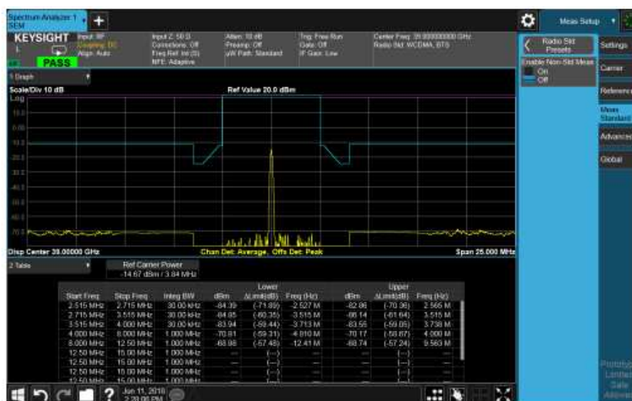
Рисунок 1.5 – Результати вимірювань з використанням спектральної маски
