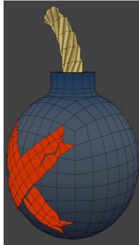
Рисунок 6 – Висяча геометрія надає деталізацію моделі, при цьому не порушується правильність топології самої моделі
