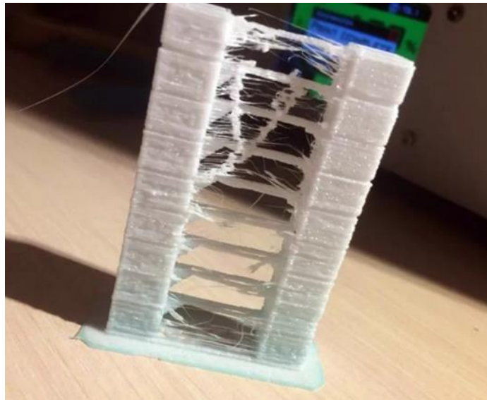
Рисунок 1.21 – Приклад спінювання та утворення пухирів при друкуванні
