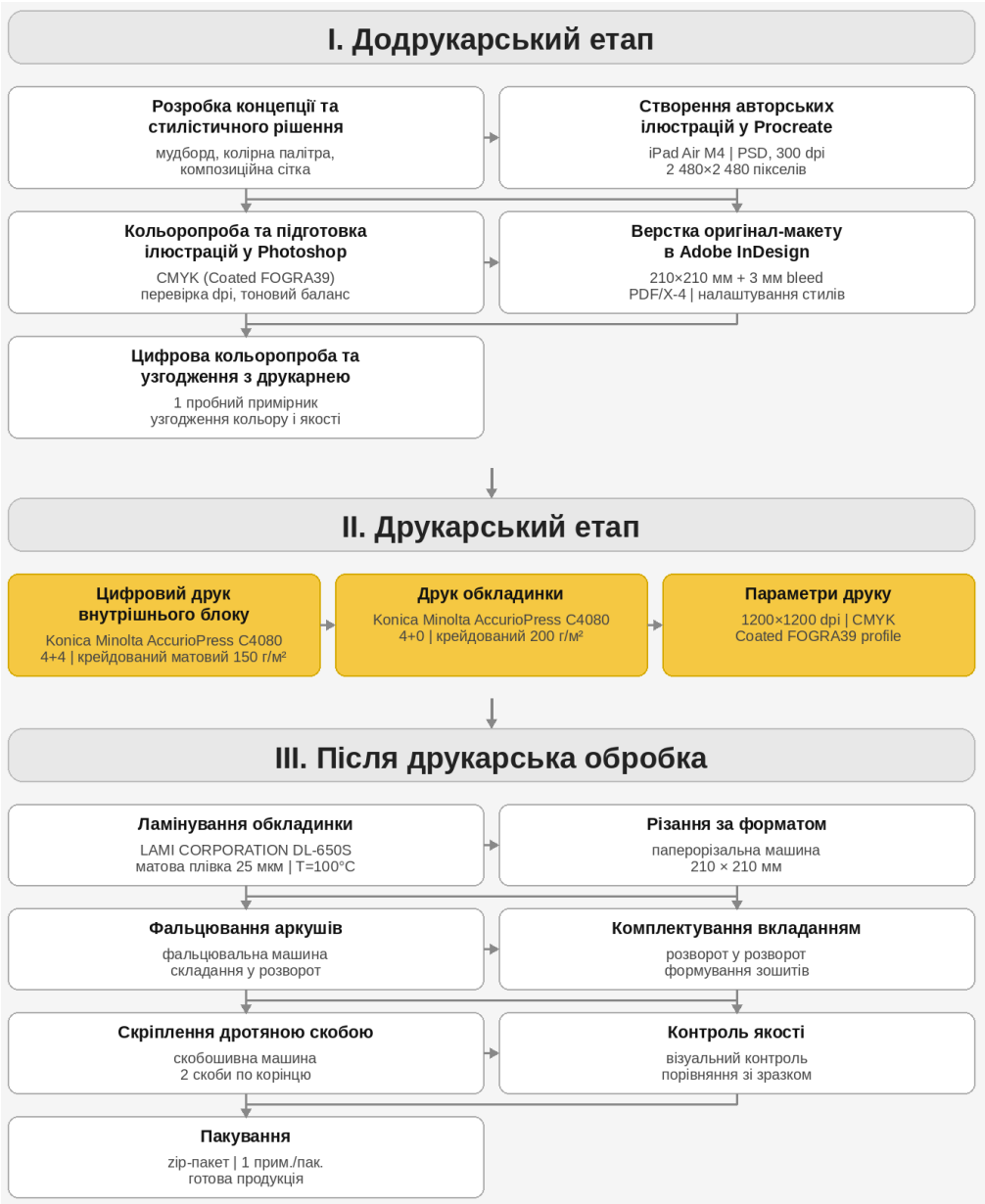
Рисунок 5.1 – Структурна схема технологічного процесу виготовлення артбуку Джерело: власна розробка
