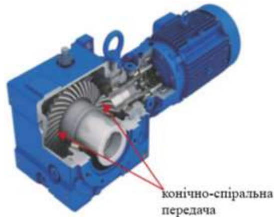
Рисунок 1.15 - Внутрішній механізм редуктора з конічно-спіральною або швидкісною передачею
