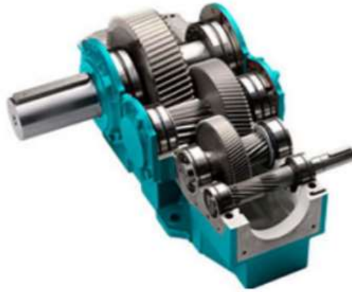
Рисунок 1.16 - Внутрішній механізм циліндрично-гвинтового редуктора
