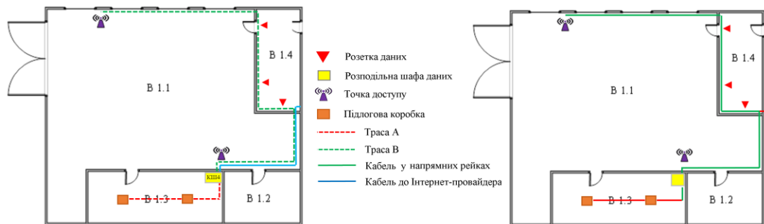
Рисунок 3.6 – План прокладки кабельних трас у будівлі В
