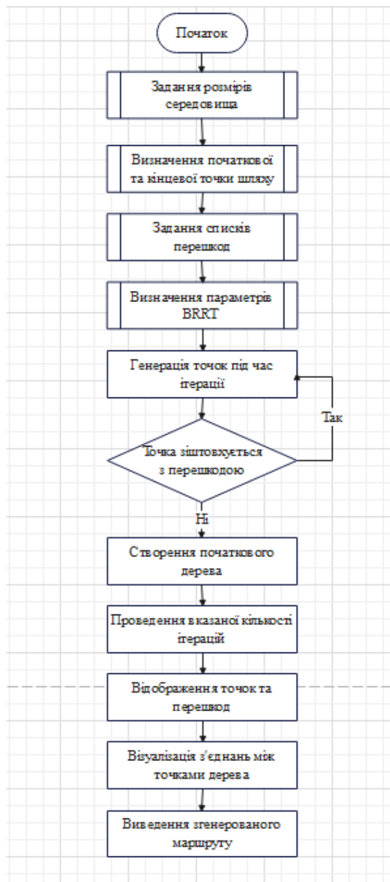
Рисунок 4.3 – Загальний алгоритм роботи програми
