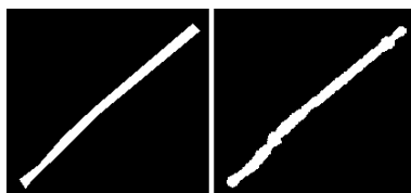
Рисунок 3.10 – Порівняння сегментації провідника: ground truth проти результату моделі
