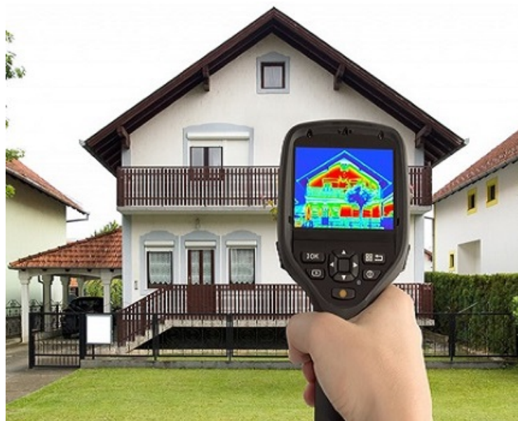
Рисунок 1.4 – Тепловізор при обстеженні будівель
