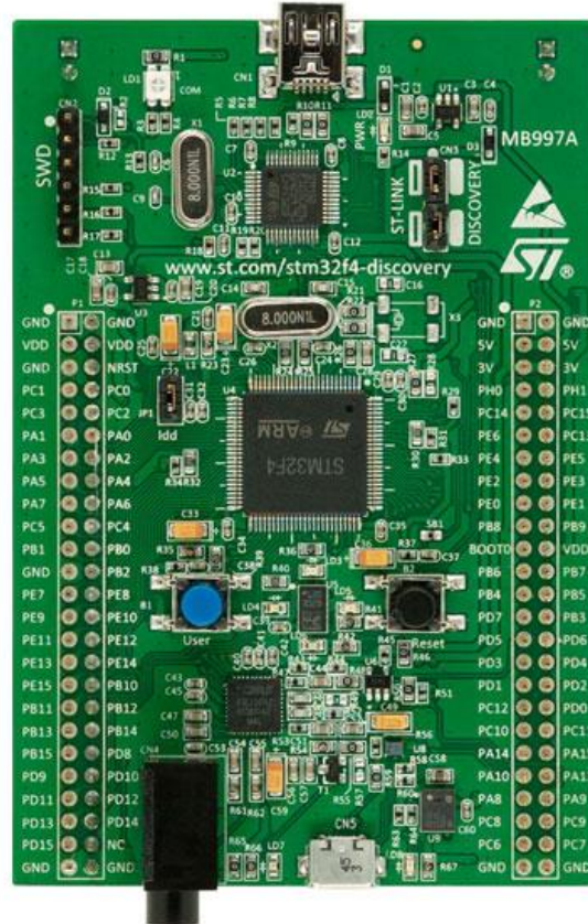
Рисунок 2.1 – Мікроконтролер STM32F407VG Discovery
