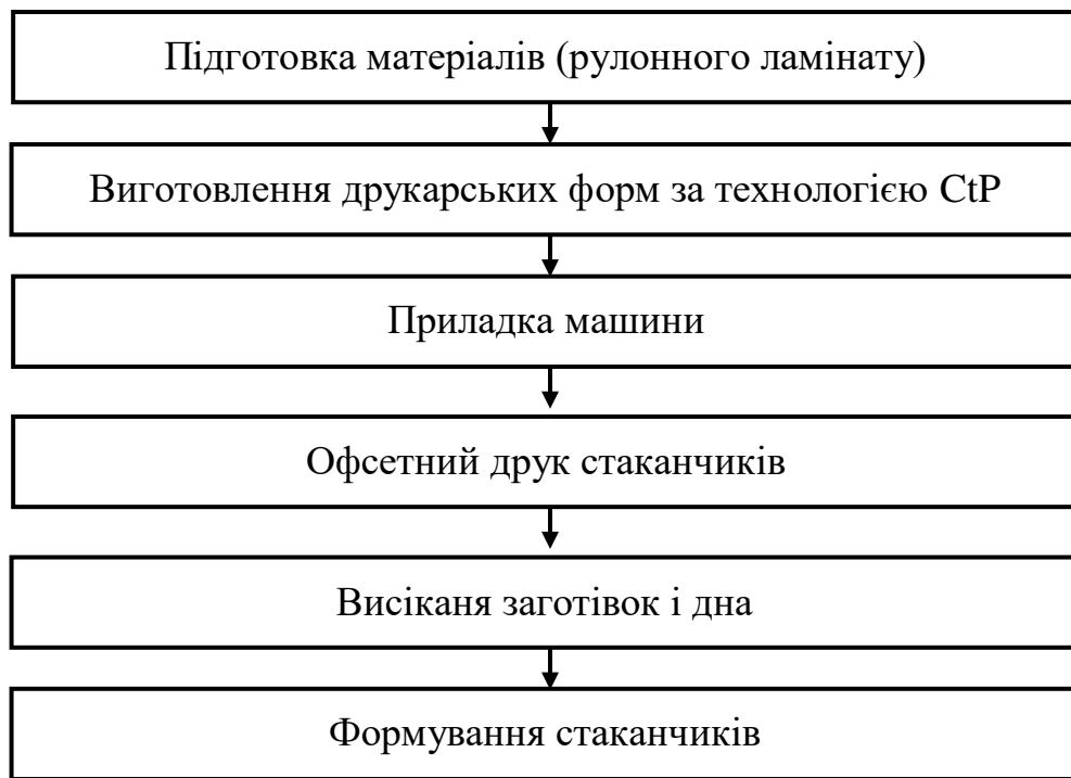
Рисунок 5.2 – Технологічна схема виготовлення стаканчиків
