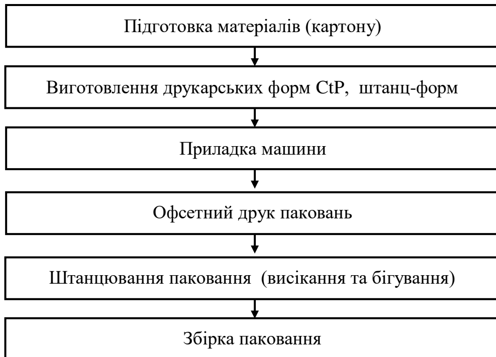
Рисунок 5.1 – Технологічна схема виготовлення паковань
