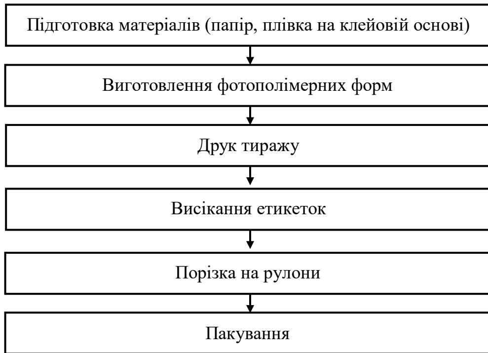
Рисунок 5.3 – Технологічна схема виготовлення етикеток флексодруком
