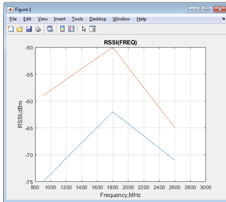
Рисунок 4.10 – Залежність рівню сигналу досліджуваних антен в залежності від діапазонів: вбудована (синій), розроблена (червоний)
