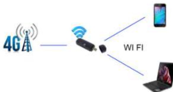
Рисунок 3.1 – Принцип надання підключення абонентських пристроїв до мережі із використанням 4 G WI FI модему
