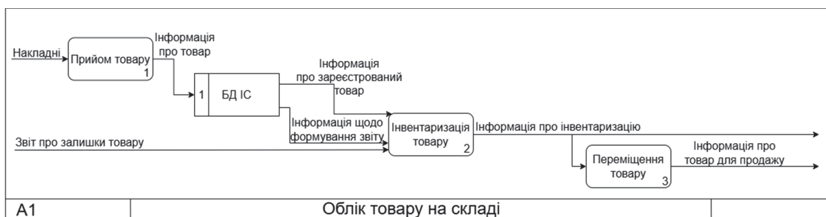
Рисунок 4.3 – DFD-діаграма декомпозиції другого рівня процесу обліку товару на складі інформаційної системи магазину електроніки
