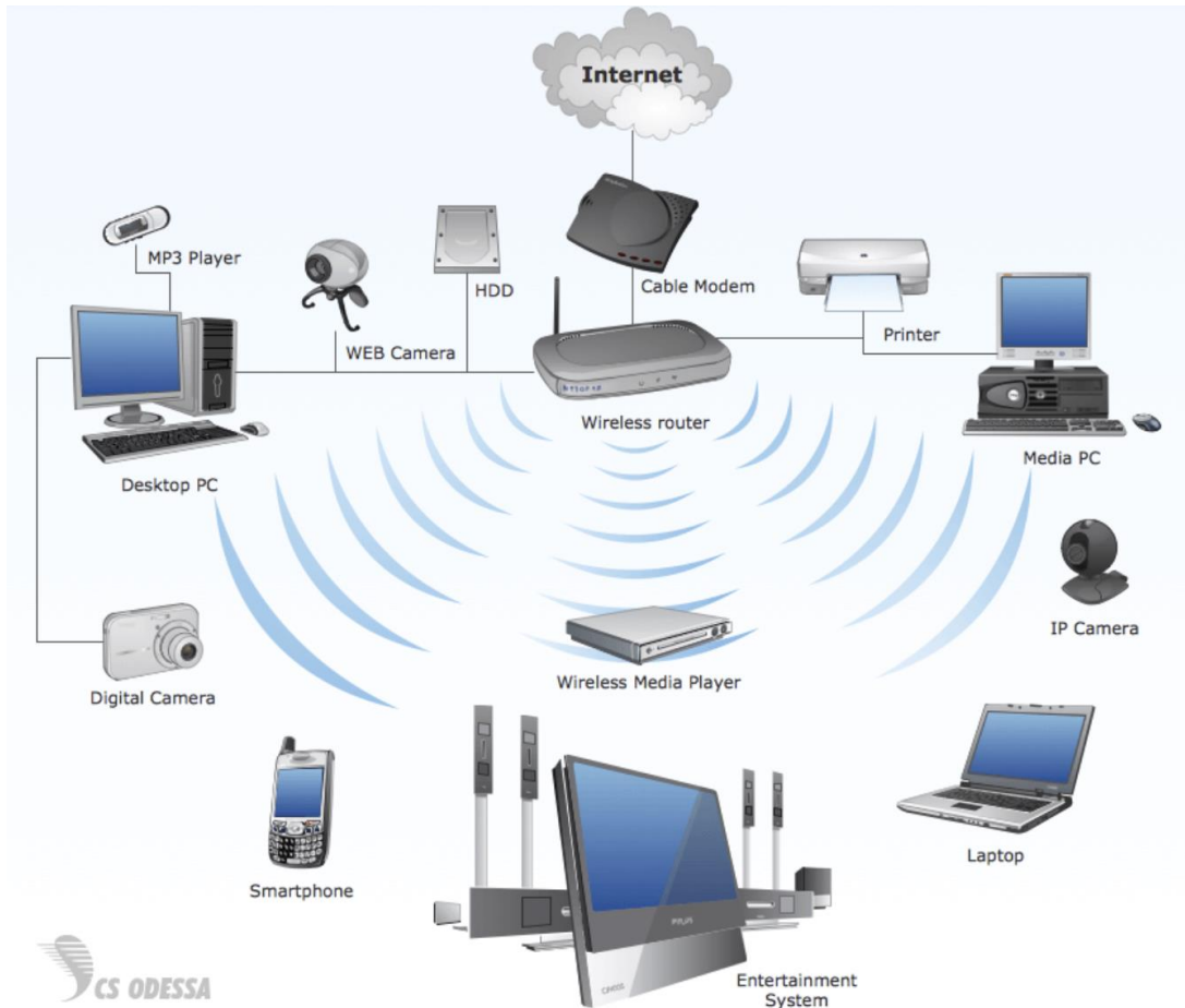
Рисунок 1.4 - Пристрої, які можуть працювати в режимі AP-client
