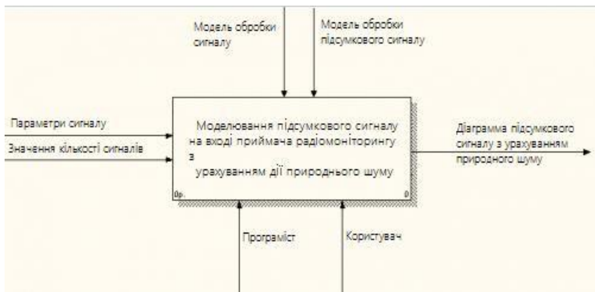
Рисунок 2.2 – Контекстна діаграма моделювання сигналу
