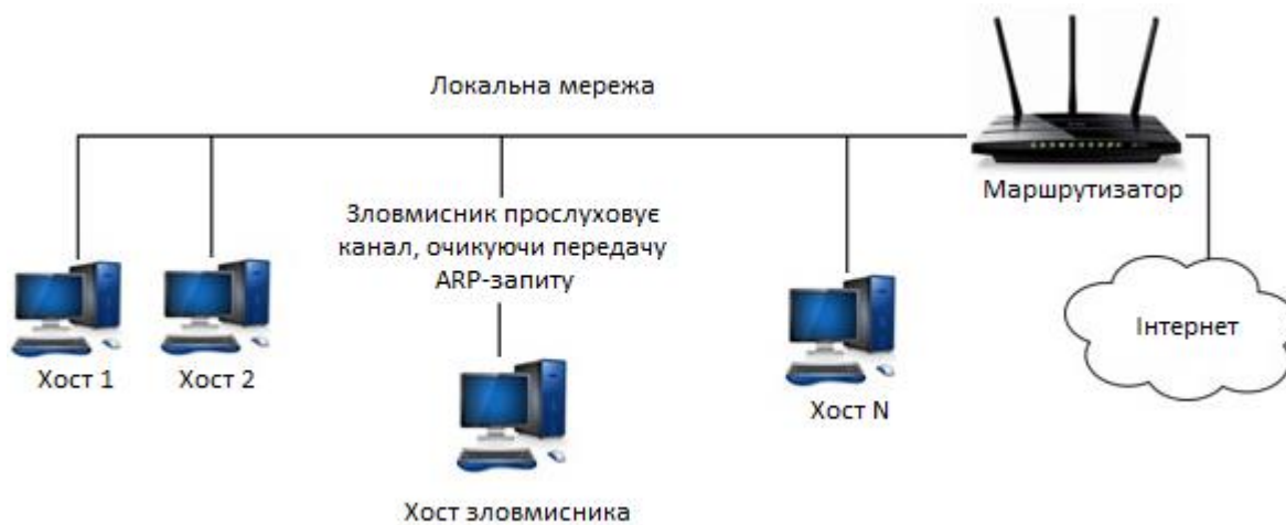
Рисунок 2.10 – Атака через хибні запити ARP на хост 2
