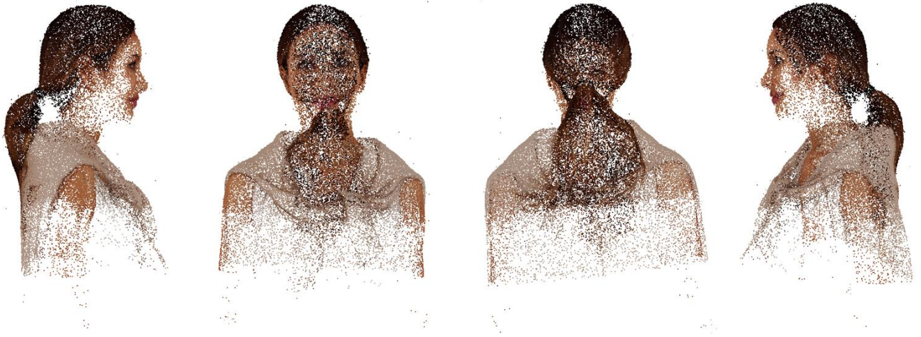
Рисунок 2.23 – Результат створення Tie Points на основі 100 фотографій на білому фоні
