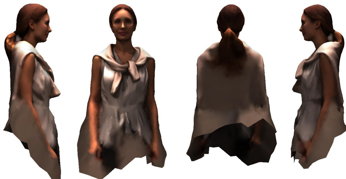
Рисунок 2.62 – Результат створення Build Mesh на основі 175 фотографій в кімнаті
