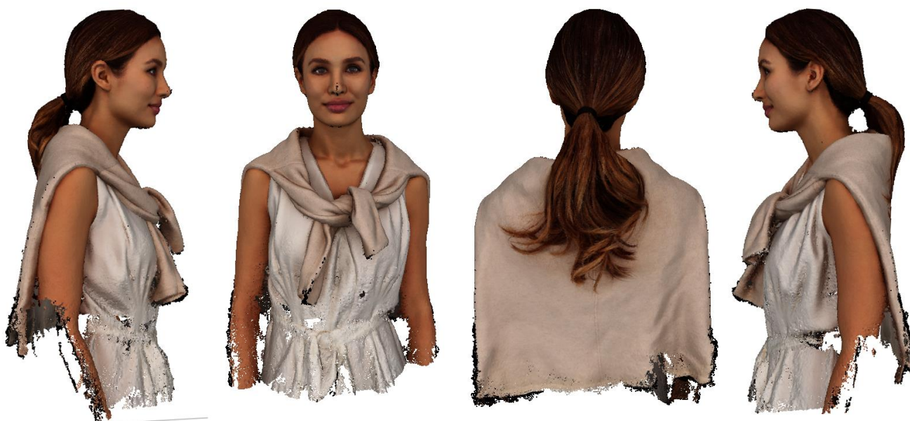
Рисунок 2.38 – Результат створення Point Cloud на основі 175 фотографій на чорному фоні
