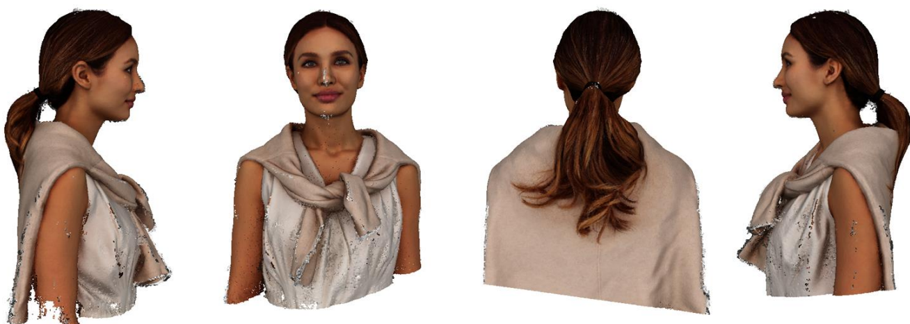
Рисунок 2.10 – Результат створення Point Cloud на основі 250 фотографій на білому фоні
