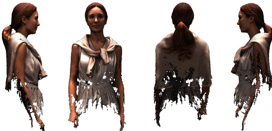
Рисунок 2.61 – Результат створення Point Cloud на основі 175 фотографій в кімнаті
