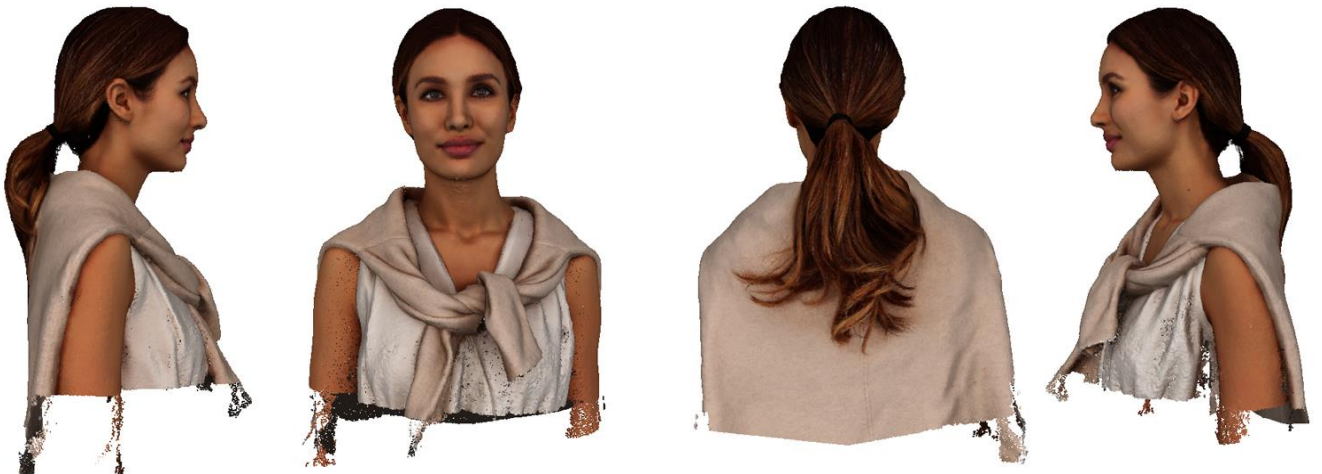
Рисунок 2.24 – Результат створення Point Cloud на основі 100 фотографій на білому фоні
