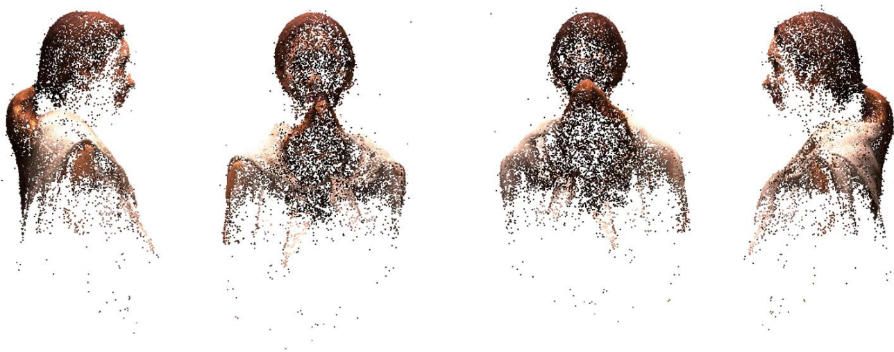
Рисунок 2.68 – Результат створення Tie Points на основі 100 фотографій в кімнаті
