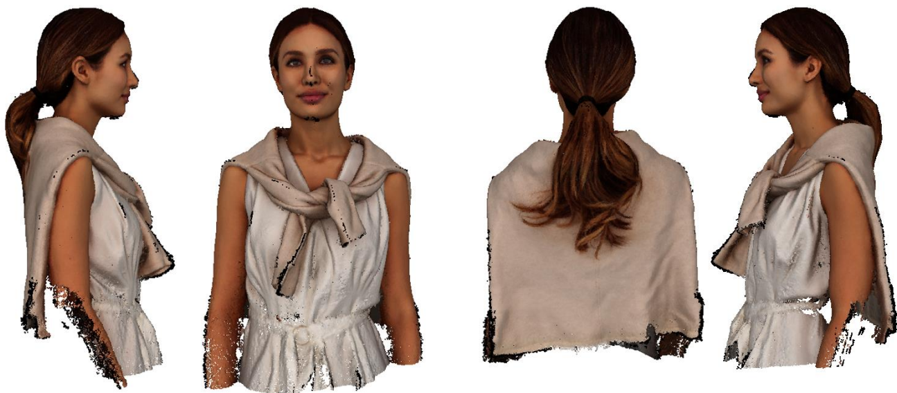
Рисунок 2.31 – Результат створення Point Cloud на основі 250 фотографій на чорному фоні
