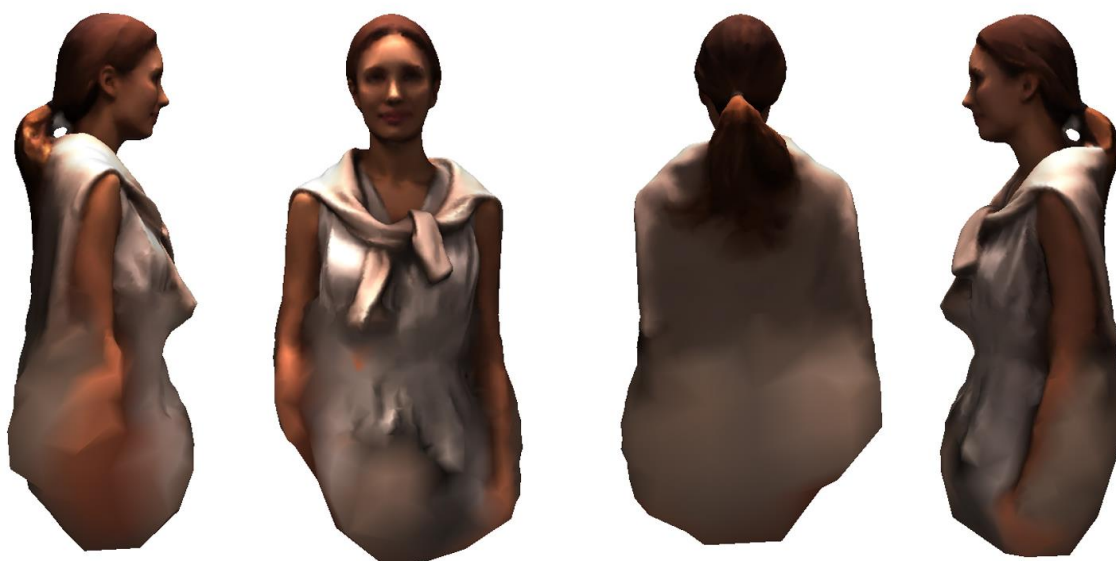
Рисунок 2.70 – Результат створення Build Mesh на основі 100 фотографій в кімнаті
