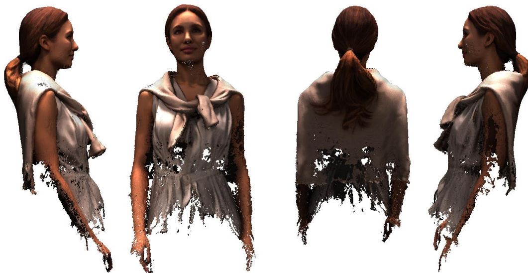
Рисунок 2.52 – Результат створення Point Cloud на основі 250 фотографій в кімнаті
