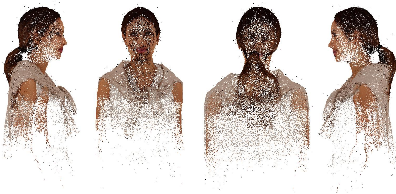
Рисунок 2.37 – Результат створення Tie Points на основі 175 фотографій на чорному фоні
