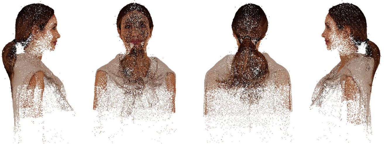
Рисунок 2.16 – Результат створення Tie Points на основі 175 фотографій на білому фоні
