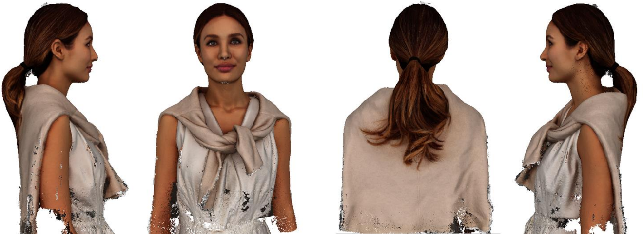
Рисунок 2.17 – Результат створення Point Cloud на основі 175 фотографій на білому фоні
