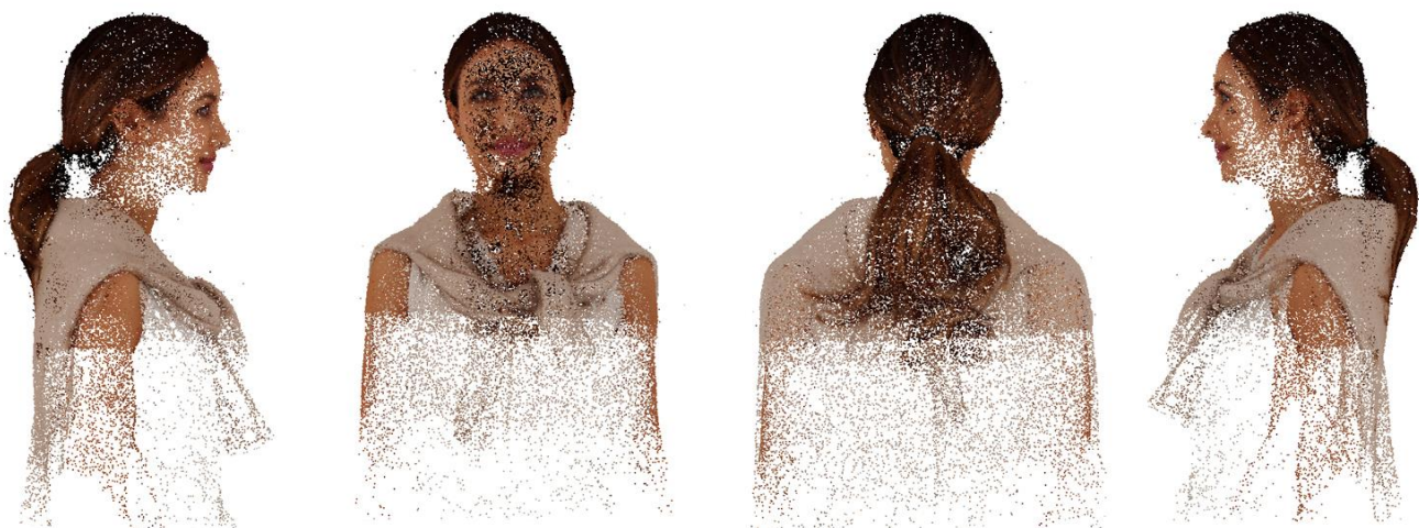
Рисунок 2.9 – Результат створення Tie Points на основі 250 фотографій на білому фоні
