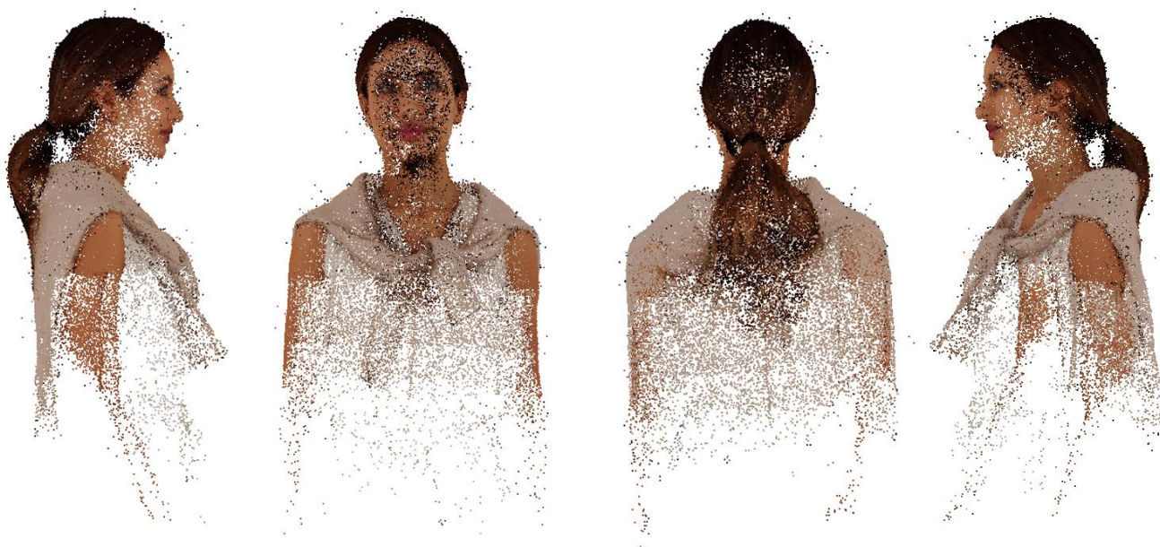
Рисунок 2.30 – Результат створення Tie Points на основі 250 фотографій на чорному фоні
