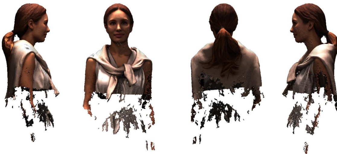
Рисунок 2.69 – Результат створення Point Cloud на основі 100 фотографій в кімнаті
