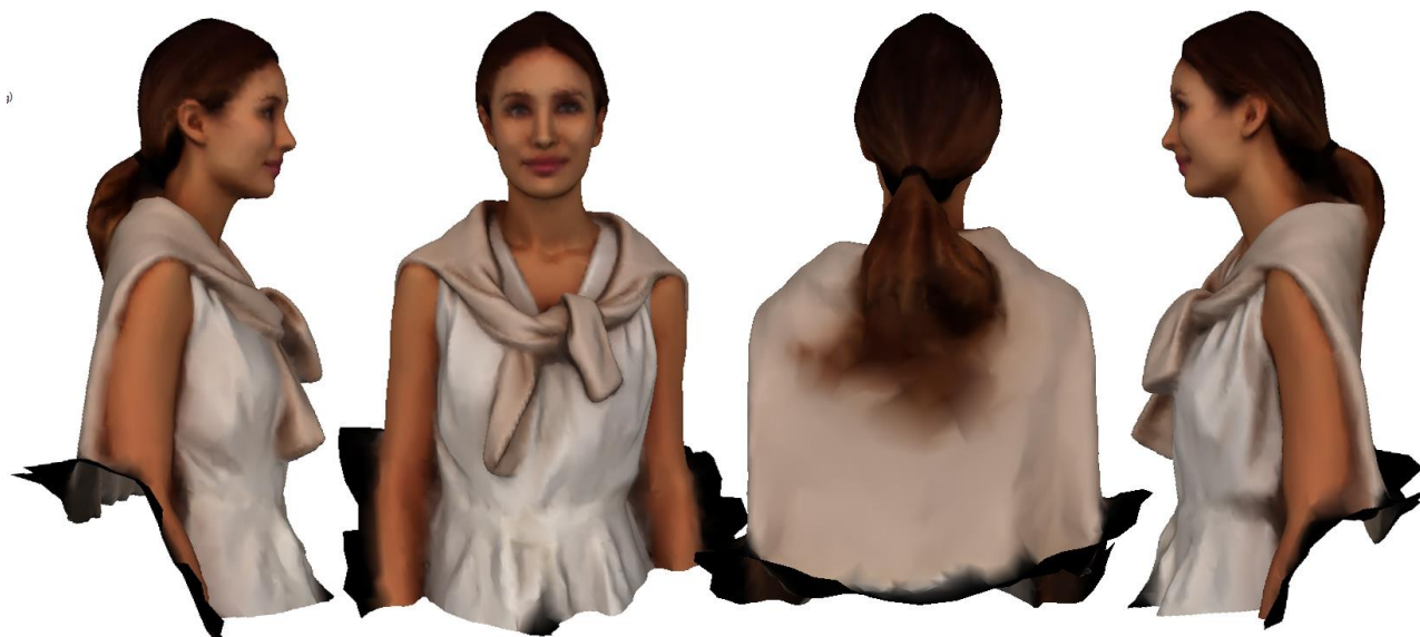
Рисунок 2.39 – Результат створення Build Mesh на основі 175 фотографій на чорному фоні
