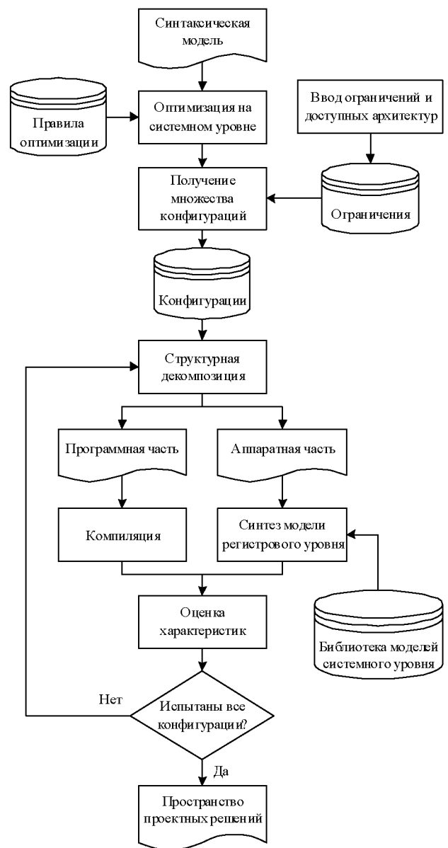
Рис. 5. Процесс построения пространства проектных решений
