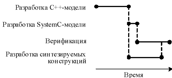
Рис. 18. График проектирования устройства с использованием SystemC-прототипов
