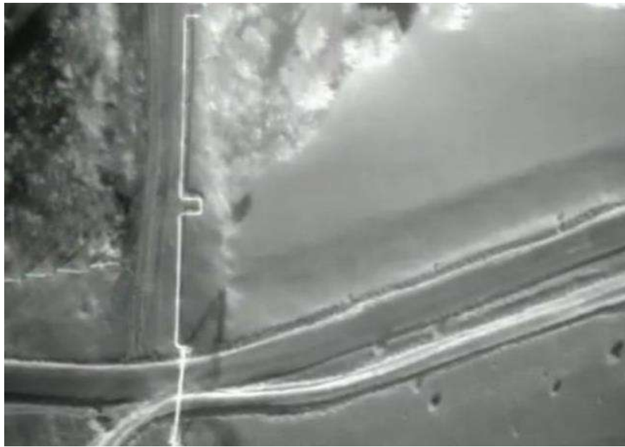
Рисунок 1.3 – Приклад фотознімку трубопроводу в інфрачервоному (ІЧ) діапазоні для визначення фактів незаконного врізання [3]
