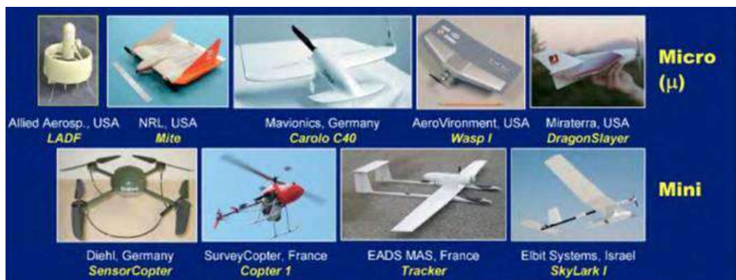
Рисунок 1.8 – Приклади БПЛА, що належать до категорій Мікро та Міні
