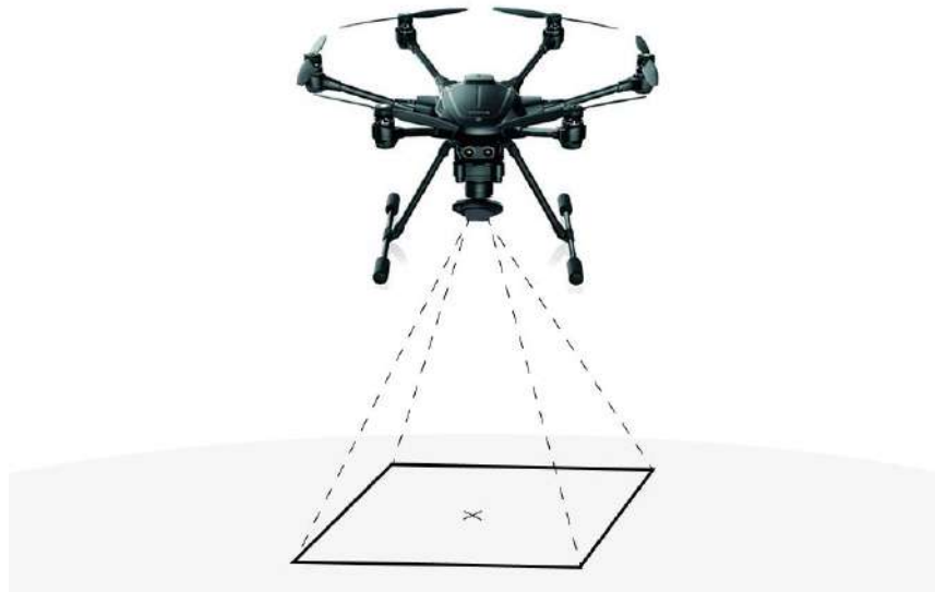
Рисунок 4.2 – Схематичне зображення положення камери на мультикоптері
