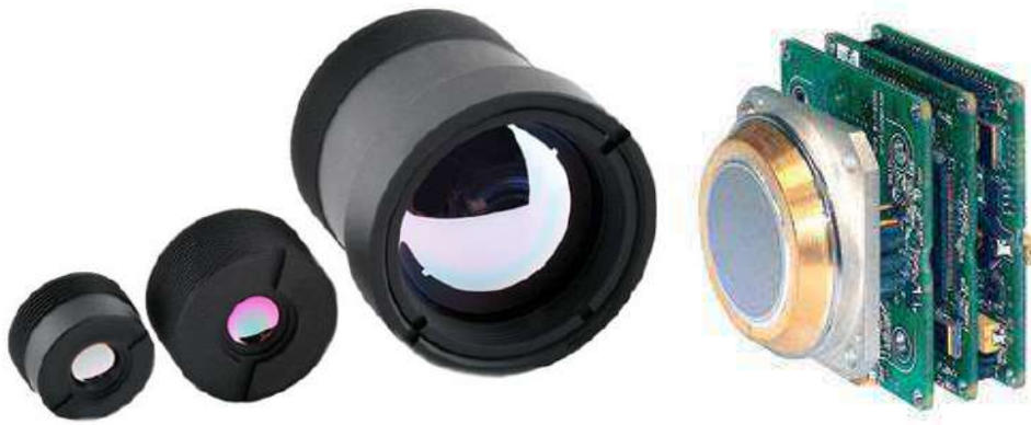
Рисунок 3.3 – Германієві об'єктиви та болOMETрична матриця
