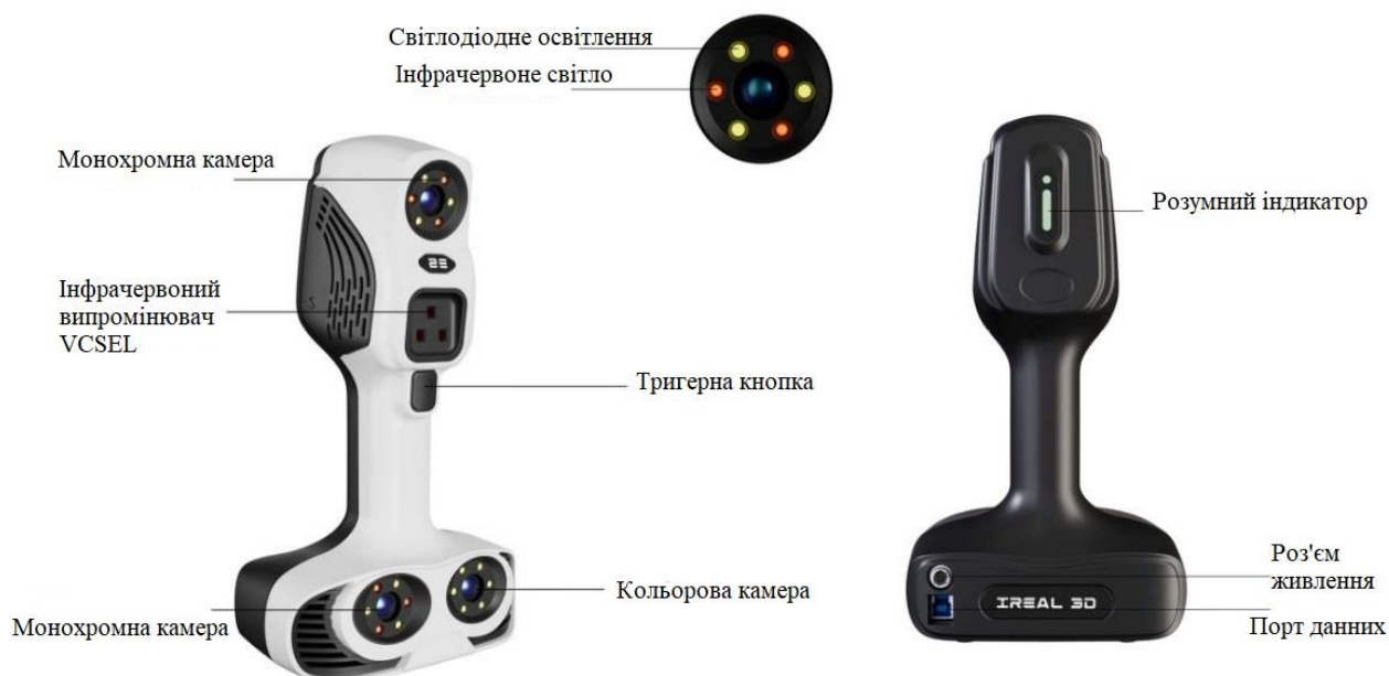
Рисунок 2.4 – Структура 3D-сканера iReal 2E
