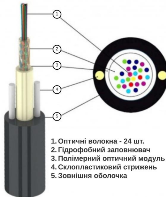
Рисунок 1.2 – Конструкція оптичного кабелю марки Lankore UT-024 SM
