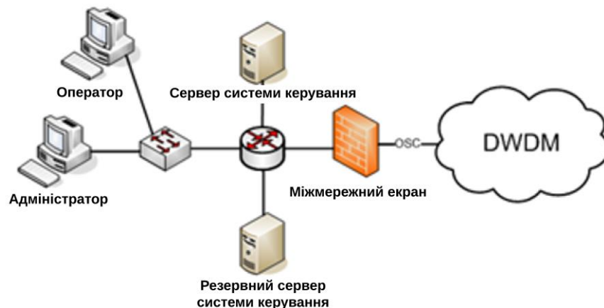
Рисунок 4.3 – Схема підключення системи керування DWDM із використанням міжмережевого екрану
