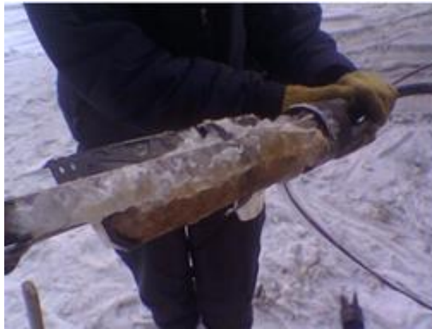
Рисунок 4.1 – Наслідки промерзання оптичної муфти
