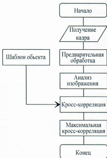
Рис. 2. Алгоритм поиска объекта с использованием кросс-корреляции [7]
