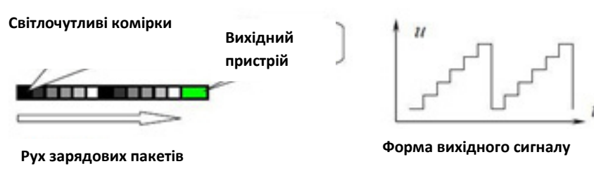
Рисунок 1.17 – Принцип пристрою лінійки ПЗС
