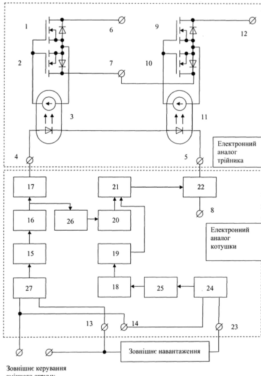
Корисна модель належить до імпульсної техніки та може використовуватись для комутації ланцюгів постійного і змінного струмів у приладах автоматики та інформаційно-вимірювальної техніки.
